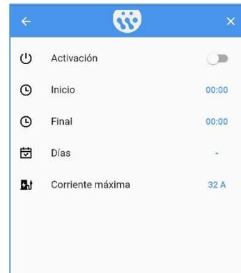
Aunque se especifique una corriente máxima de recarga superior a la programada para el equipo, el punto de recarga jamás excederá la potencia especificada para el equipo. Así pues, si no se desea limitar la carga para el intervalo, seleccione el valor máximo (32 amperios) como límite de corriente de recarga.
